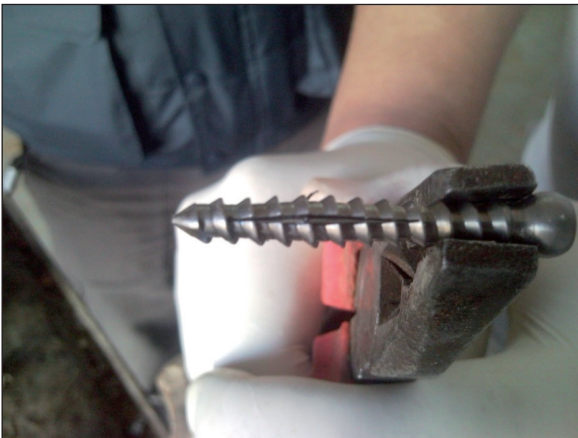
Şekil 5: Açılıp-kapanabilen transpediküler vida ve içerisindeki pimi.
