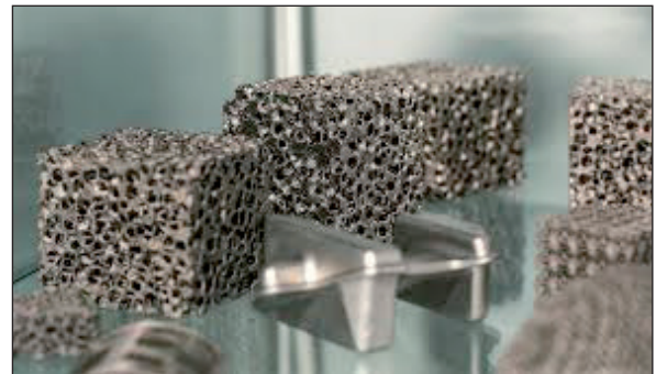
Şekil 15: Üç boyutlu yazıcıda üretilen köpük yapıda köpük kafes (Maksimum füzyon alanı).
